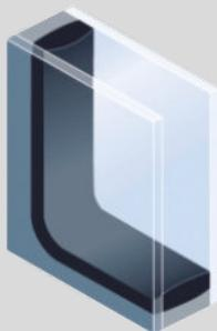
Struttura con TPS® applicato tramite estrusione
