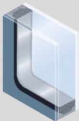
Structure du type traditionnel avec intercalaire métallique et tamis moléculaire
